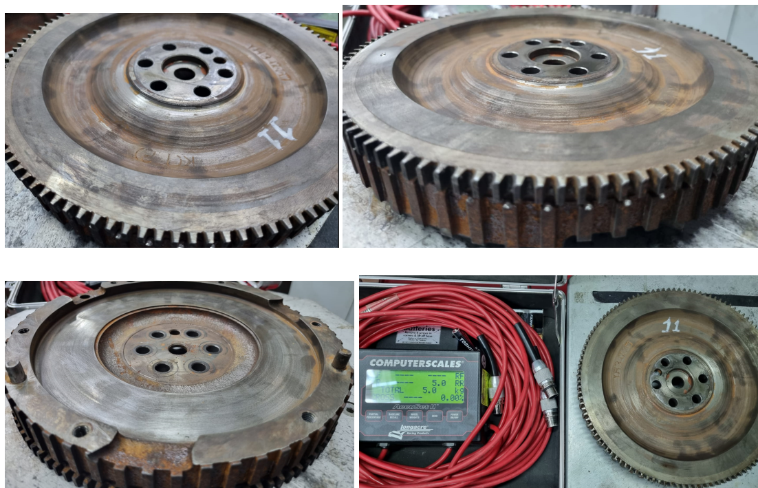
Fig2 – Volante de motor alterado, não conforme:
